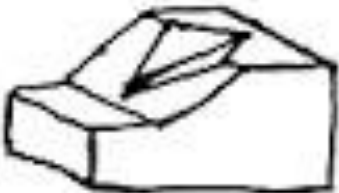
Falla en Cuña
