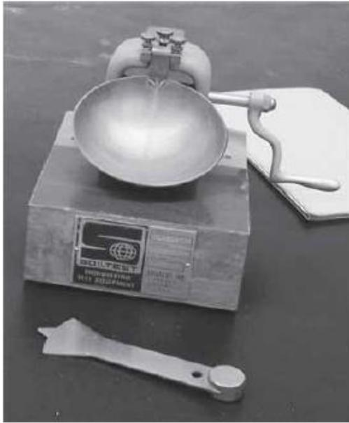
Figura 3.10 Dispositivo de límite líquido (derson, Nevada)
