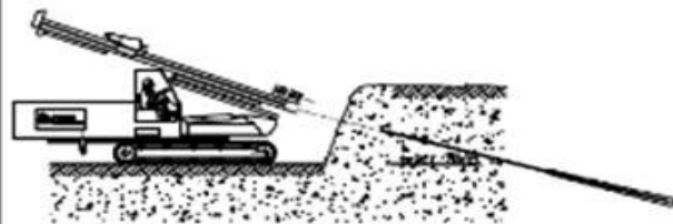
2ª ETAPA - EJECUCION ANCLAJE
