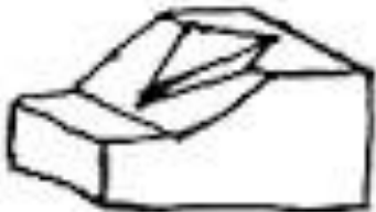
Falla en Cuña
